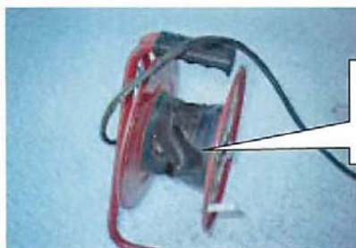
巻いたまま使用、変形、注意書き読むこと 漏電保護付きもあります 多用は禁物、漏電、感電の危険も多い
